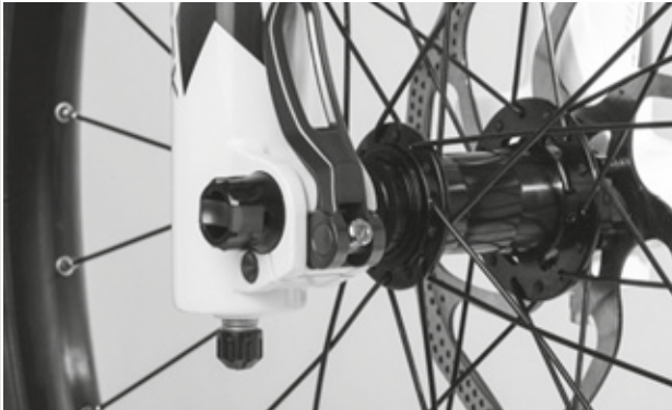
Illustration 101 : Régler la force de serrage de l'attache rapide
