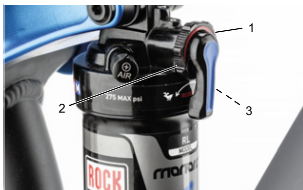
Illustration 96 : Régler la dureté de l'amortisseur de détente via la molette de réglage (1) de l'amortisseur arrière
