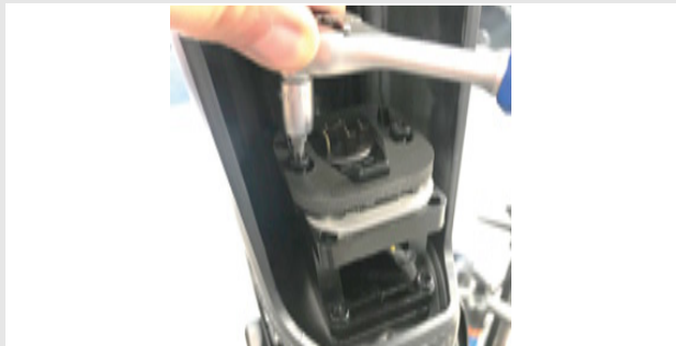
Illustration 27 : Desserrez les vis du logement de batterie
