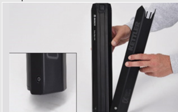
Illustration 35 : Enfoncer le capot de batterie sur la batterie
