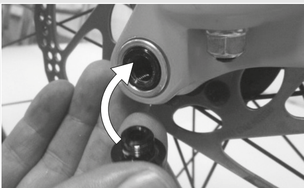
Illustration 42 : Enfoncer le levier d'attache rapide dans l'axe
