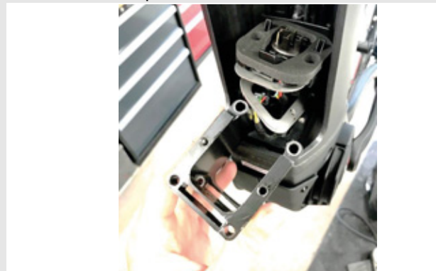
Illustration 30 : Retirer l'adaptateur PowerTube
