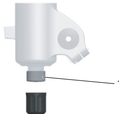
Illustration 74 : Dispositif de réglage de la détente FOX (1) sur l'extrémité de fourche
