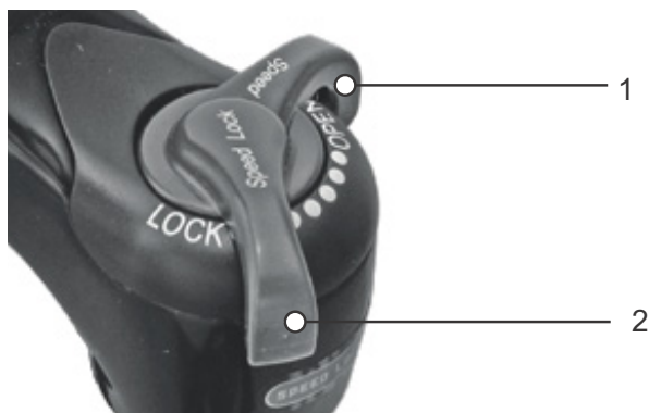
Illustration 95 : Dispositif de réglage de la compression Suntour avec les positions OPEN (1) et LOCK (2)
