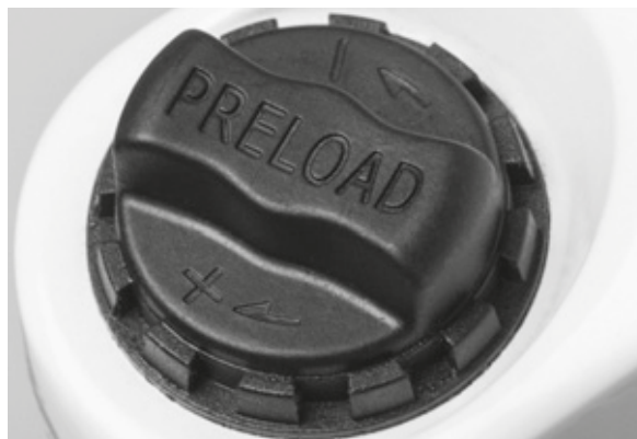
Illustration 71 : Molette de réglage de la course de suspension négative sur la couronne de la fourche de suspension
