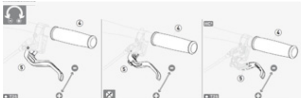
Illustration 69 : Régler la garde d'un levier de frein à disque Magura
