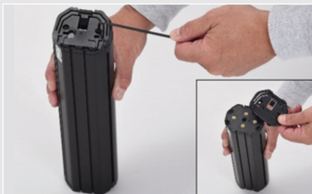
Illustration 33 : Démontage de l'interface supérieure
