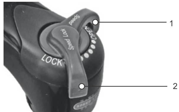
62. ábra: Suntour nyomásfokozat-lengéscsillapító nyitott (1) és zárt (2) helyzetben
