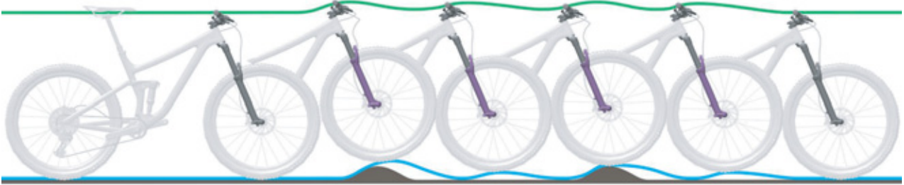
70. ábra: A teleszkópos villa túl gyors kirugózása
