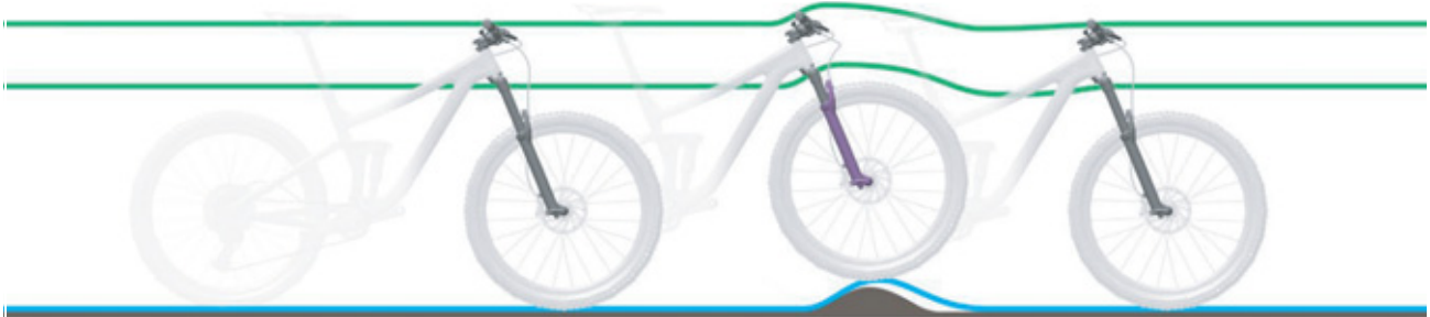
76. ábra: A teleszkópos villa túl kemény csillapítása egyenetlenségeknél
