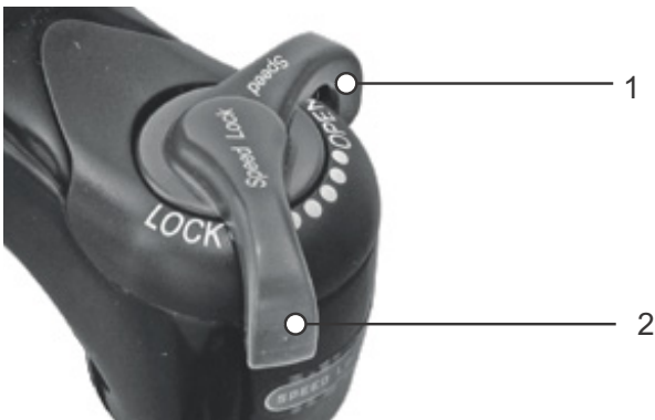
77. ábra: Suntour nyomásfokozat-lengéscsillapító nyitott (1) és zárt (2) helyzetben
