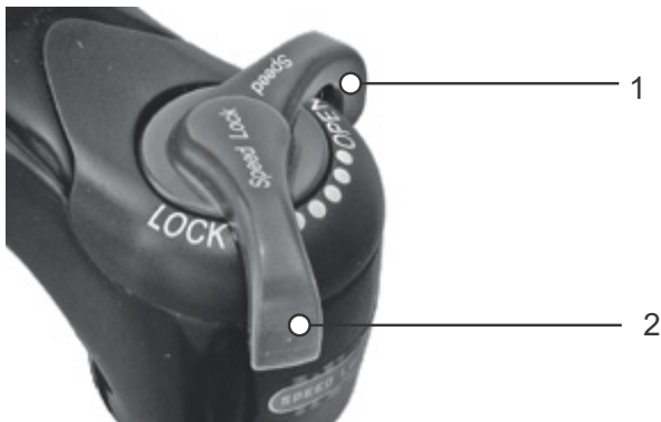
75. ábra: Suntour nyomásfokozat-lengéscsillapító nyitott (1) és zárt (2) helyzetben
