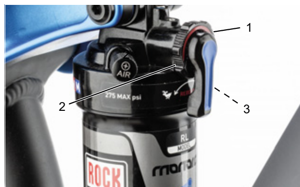
Rysunek 96: Ustawianie twardości tłumika odbicia za pomocą pokrętła regulacyjnego (1)
