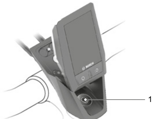
Rysunek 87: Usytuowanie śruby zespołu sterowania
