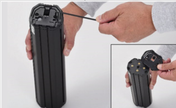
Rysunek 36: Demontaż górnego interfejsu
