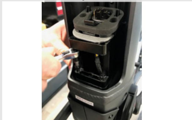
Rysunek 28: Wykręcanie śrub z łbem sześciokątnym 4 mm
