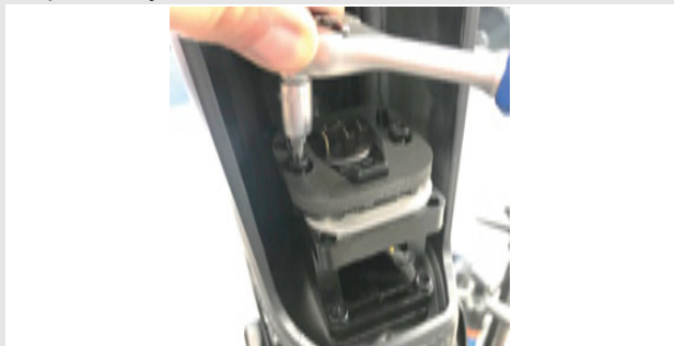
Rysunek 27: Odkręcanie śrub akumulatora
