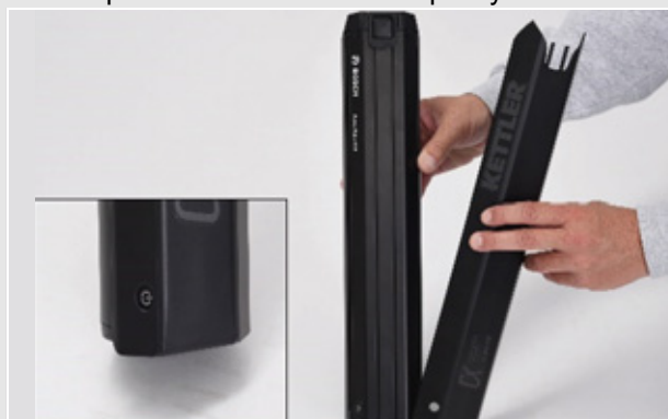
Rysunek 35: Wsuwanie pokrywy na akumulator
