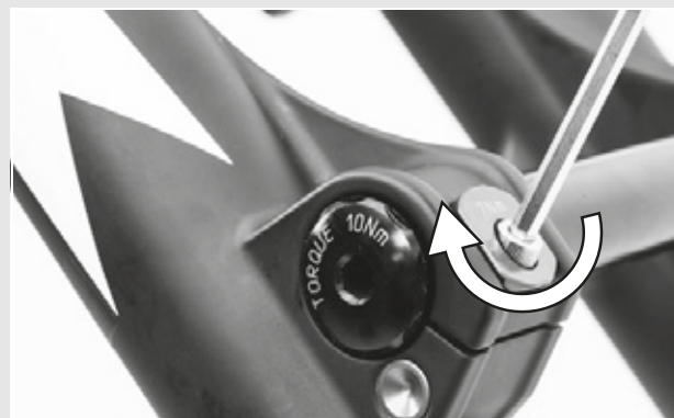
Rysunek 45: Sposób dokręcania zacisku zabezpieczającego
