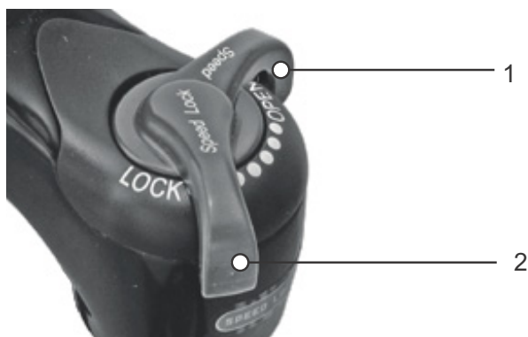
Rysunek 95: Nastawnik dobicia Suntour z pozycjami OPEN (1) i LOCK (2)
