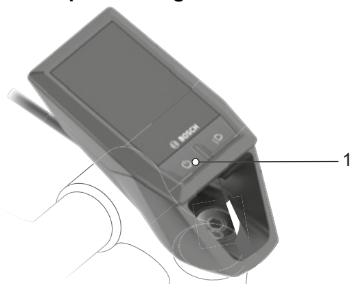
Rysunek 89: Położenie przycisku Zał.-Wył. (komputer pokładowy)
