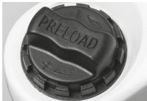
Rysunek 71: Pokrętło regulacyjne ujemnego skoku sprężyny, usytuowane na koronie widelca amortyzowanego
