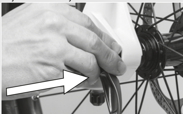
Rysunek 53: Wsuwanie zacisku szybko mocującego
