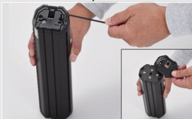
Rysunek 33: Demontaż górnego interfejsu
