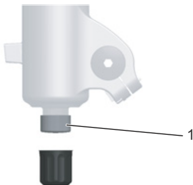
Rysunek 74: Nastawnik odbicia FOX (1) na zabezpieczeniu widelca przed wypadnięciem
