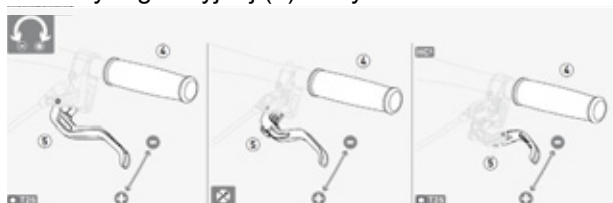
Rysunek 69: Ustawianie odchylenia manetki dźwigni hamulca tarczowego Magura
