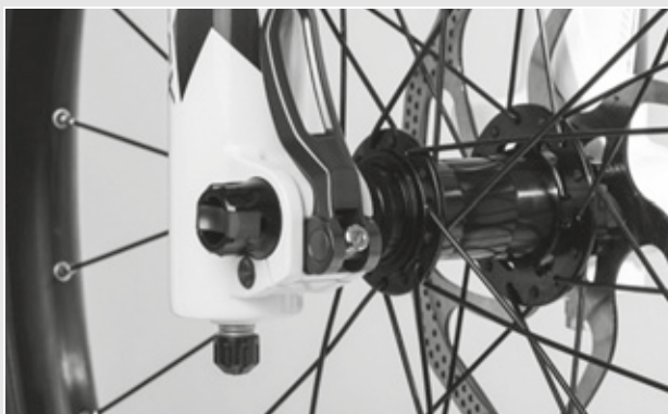
Rysunek 50: Optymalne położenie dźwigni mocującej
