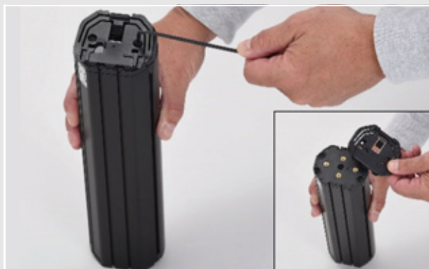
Obr. 32: Demontáž horního rozhraní
