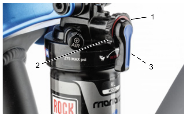
Obr. 88: Nastavení tvrdosti tlumiče odskoku zadního odpružení nastavovacím kolečkem (1)
