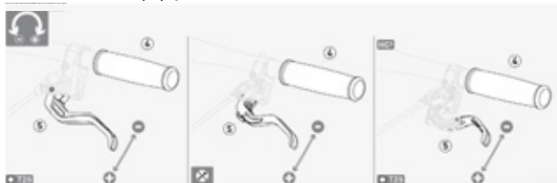
Obr. 68: Nastavení vzdálenosti brzdové páky kotoučové brzdy Magura
