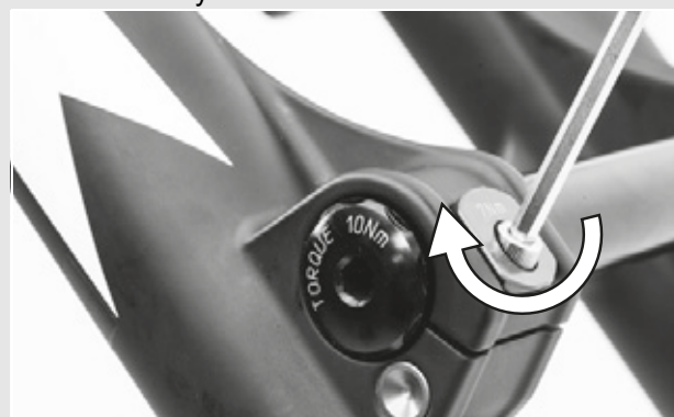
Obr. 44: Utažení pojistné svorky
